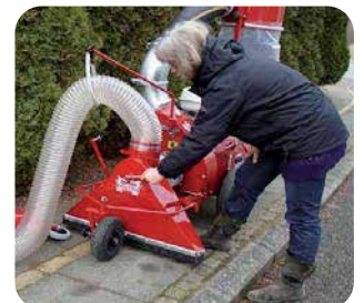
Bredsugestuds med omskifter - hurtigskift fra slange til bredslug.
